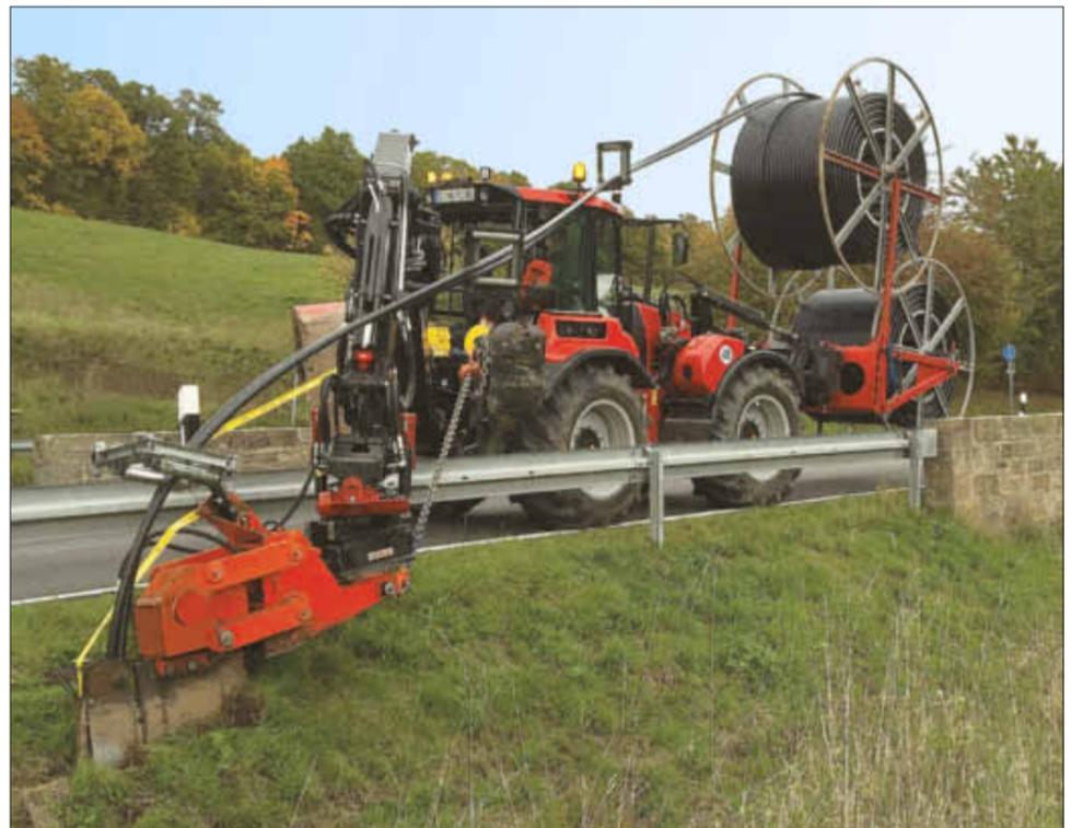
Beim Breitbandausbau wird auf modernste Technik gesetzt. Dieser Pflug baut in einem Arbeitsgang Leerrohre für die Netzkabel ein. Foto: econtech
