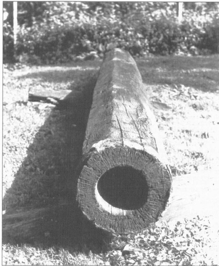
*Erlenholzrohr der ersten St. Wendeler Wasserleitung; gefunden 1980 beim Bau der Tiefgarage in der „Mott“*
