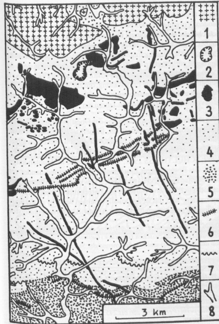
Abb.: 4: Das Einzugsgebiet der oberen Oster im geologischen Kartenbild (vgl. DREYER, FRANKE & STAPF 1983) Alter der Gesteine: Oberkarbon und Unterperm 1 = An der Erdoberfläche erstarrte Lavagesteine (effusives Magmatite); 2. = Weiselbergit (effusives Magmatitgestein); 3 = In der Erdkruste erstarrte Lavagesteine (intrusive Magmatite). Die Magmatite, die als Füllungen von nordwest-südost-verlaufenden Erdspalten auftreten, ent-
